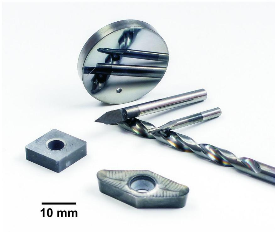
Superharte spannungsfreie ta-C-Schichten abgeschieden auf verschiedenen Werkzeugen und Materialien.
