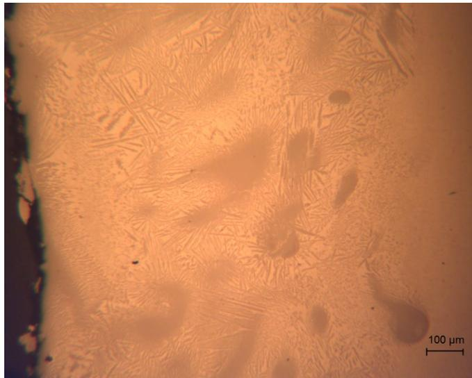
Mikroskopaufnahme eines Schliffes zum Nachweis der Eisen-Aluminid-Bildung bei einer mittels Laserauftragschweißen aufgetragenen Schicht auf AlMgSi
