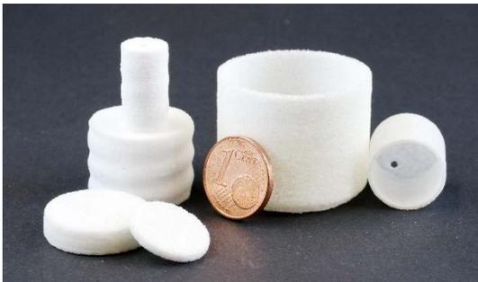
Bild 1: Formkörper aus Kieselglas, hergestellt mittels HT-SLS
