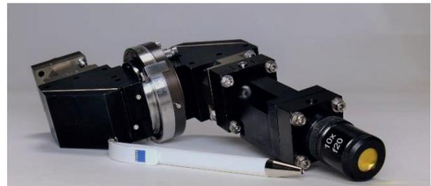
Bild 4: Strahlformungsoptik für das Lasertrennen von Gläsern.
