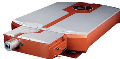
Bild 1: Tangor UV liefert mit dem gezeigten Frequenzkonvertierungs-Modul bis zu 50 W UV (343 nm) bei Pulsdauern unter 1ps.
