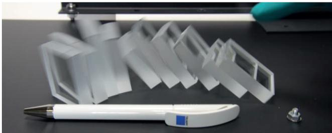
Bild 3: Glas Samples getrennt nach Modifikation mit strahlgeformtem Ultrakurzpuls-Strahl in Einzelüberfahrt.
