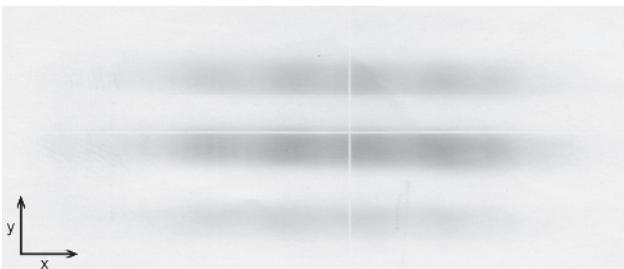
Abb. 8: Beugungsbild des Strahlformers aus Abb. 6 in einer Entfernung von 1700 mm vom DPE.
