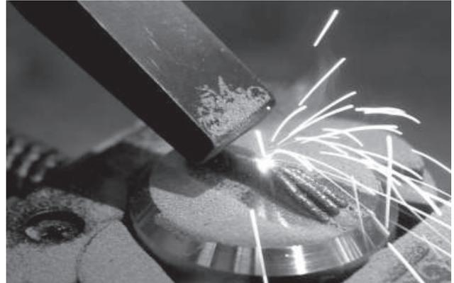
Abb. 8: Prozess Laserauftragschweißen – mehrere Spuren werden gleichzeitig erzeugt
