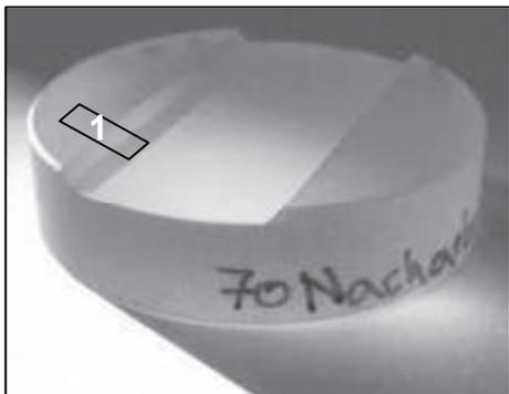
Bild 2: flächiger Abtrag in Glasronde  $D=30\text{mm}$
