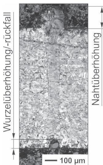
**Abb.9:** Schweißnaht mit Nahtüberhöhung und Wurzelrückfall (Parameter:  $2w_0 = 65 \mu\text{m}$ , Edelstahl)
