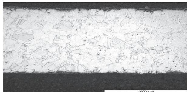
Bild 9: Mikroschliff am 1.4958 nach HT-Korrosionstest mit  $t = 1000$  h in der Brennkammeratmosphäre
