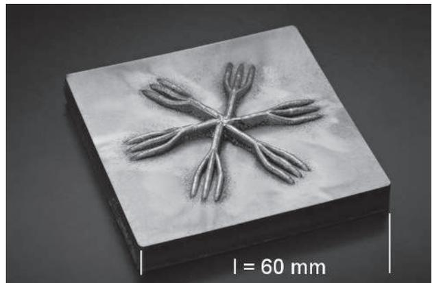
Abb. 10: Laserauftragschweißen mehrerer gleichzeitig erzeugter Spuren mit LV LineScan
