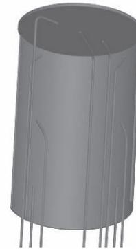
Bild 4: Anordnung der Thermoelemente in der Brennkammer
