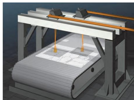
Abb. 1: Prinzip Remote-Laserschneidanlage mit kontinuierlichem Materialtransport
