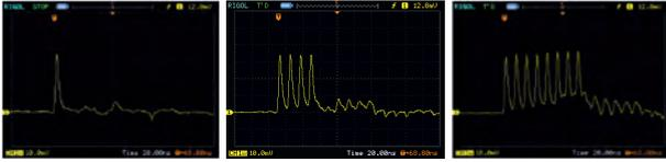
Bild 2: Aufnahmen von Bursts mit einem, vier und acht Pulsen im Burst.
