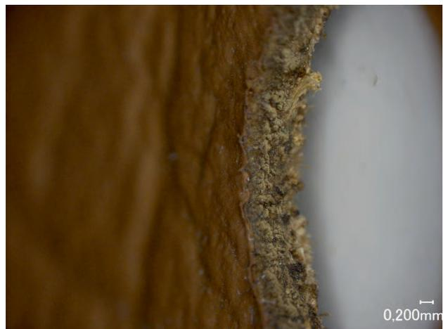
Bild 9: Schnittkante einer Bohrung in Leder
