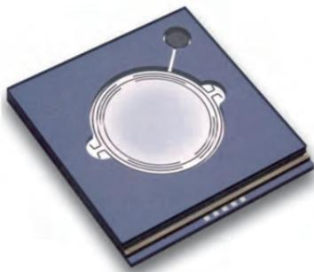
Abb. 8: Biaxialer MEMS-Scanner mit 20 mm Apertur (passiver high-Q 2D-Resonator, 2-DOF) [5]
