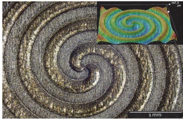
Abb 10: 2.5D-Mikroabtrag in Edelstahl mittels cw-Laser (Linien:  $10 \text{ }\mu\text{m}$ ,  $P_{cw}$ :  $400 \text{ W}$ ,  $v$ :  $200 \text{ ms}^{-1}$ , 40 Zyklen,  $w_{86}$ :  $10 \text{ }\mu\text{m}$ ) Abtrage rate:  $2\text{-}3 \text{ }\mu\text{m}$  pro Zyklus
