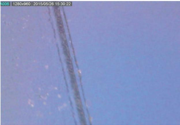
Bild 6: Schnittkante Kalk-Natron- Glasfolie 200µm dick
