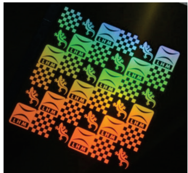
Bild 5: großflächige als Beugungsgitter wirkende sub-Mikrostrukturierung auf Edelstahl 1.4301: Größe 140 mm x 140 mm, Parameter: Wellenlänge 1064 nm, Pulsdauer 10 ps, Puls wiederholrate 20 MHz, mittlere Leistung 230 W, Fokusdurchmesser 80 \mu\text{m} , Linienabstand 12,5 \mu\text{m} , Pulsabstand 20 \mu\text{m} , 1 Überfahrt, effektive Flächenrate 633 \text{ cm}^2/\text{min} .
