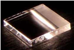
Abbildung 8: : Linienförmiger Energieeintrag auf der Probenoberfläche bei der Laserstrahlpolitur [8]
