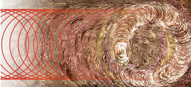
Abb. 2: Nahtoberfläche bei 1m/min Vorschub, Wobbleradius 0.5mm Freq. 100Hz.
