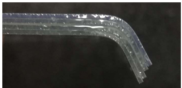
Abb. 4: Umgeformte Glaskanten an Xensation® der Fa. Schott AG
