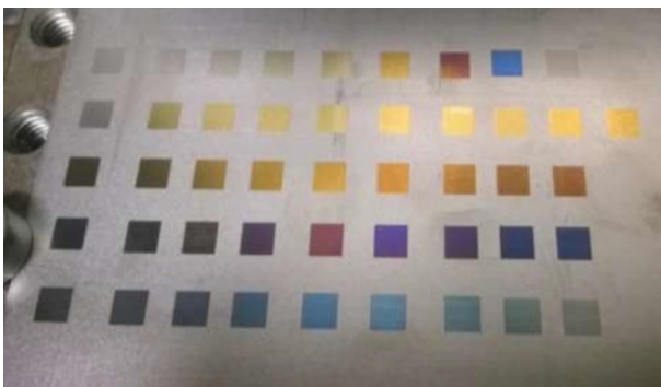
Abbildung 7: Resultierende Anlassfarben mit einem Fokussdurchmesser von 65 \mu\text{m} , einer Leistung von 25 W und einen Zeilenabstand von 50 \mu\text{m} in Abhängigkeit der Vorschubgeschwindigkeit
