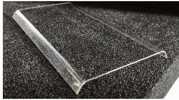
Abb. 7: Beidseitig umgeformte Alumosilikatglasprobe
