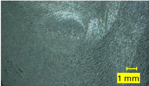
Abbildung 8: Mikroskopaufnahme einer mit einem 3-fach DOE innenbearbeiteten und mit Cold Split getrennten Fläche (Pulsdauer 50 ns, Pulsenergie 12,33  $\mu$ J, Bearbeitungstiefe 300  $\mu$ m, Pulsabstand 4  $\mu$ m, Linienabstand 4  $\mu$ m)
