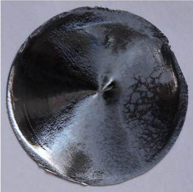
Abbildung 12: Foto von einem gesplitteten 3" Demonstrator - Wafer
