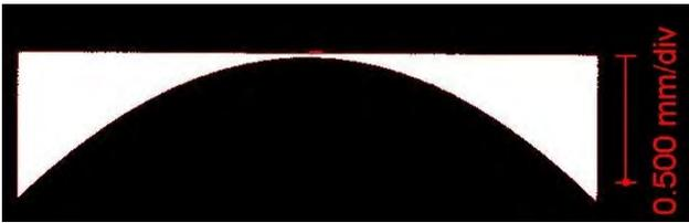
Bild 1: Mikroskopaufnahme einer Maske für die Herstellung einer 85 µm breiten Zylinderlinse.
