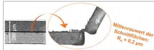
Abbildung 10: Mikroskop-Bilder, Seitenansicht auf die horizontale Defektfläche, Parameter: siehe Abbildung 9
