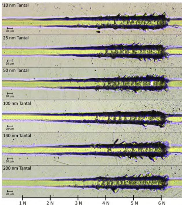
Bild 8: Haftfestigkeit mittels Scratchtest ( $R_{ind} = 50$  µm) in Abhängigkeit von der Ta-Haftschichtdicke des Schichtsystems CoCrMo / Ta ( $d_{Ta}$ ) / ta-C (2 µm).
