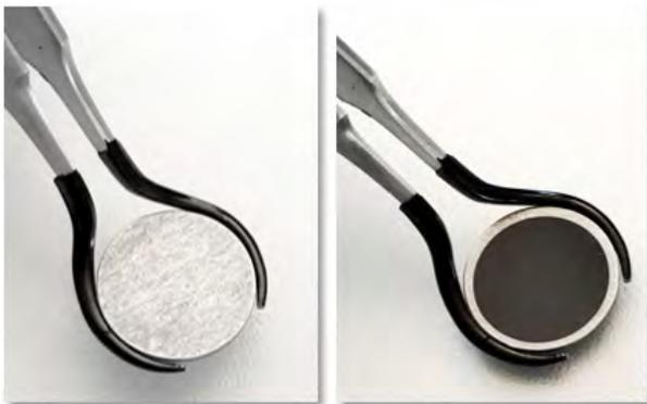
Bild 2: Strukturierte und funktionalisierte Titanprobe
