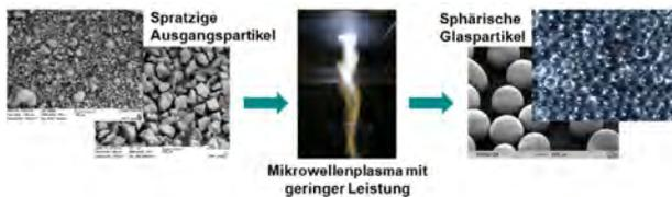
Abbildung 2: Technologiekette zur Herstellung sphärodisierter Glaspartikel mittels eines Niederleistungs- Mikrowellenplasmas [7]
