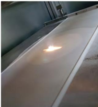
Abbildung 6: Homogene Pulverschicht auf der Bauplatzform
