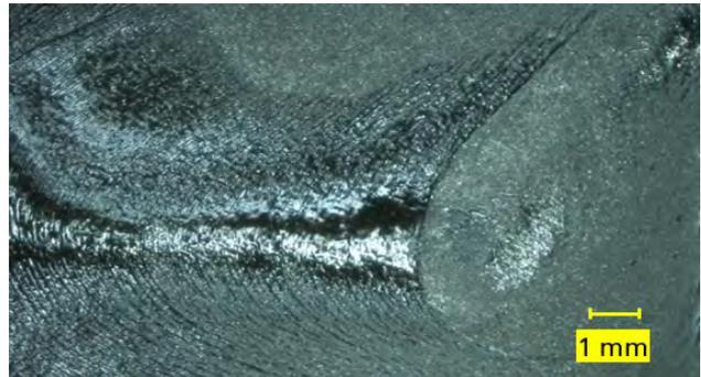
Bild 5: Mikroskopaufnahme einer Splitfläche (Pulsdauer 50 ns, Pulsenergie 4,11 µJ, Bearbeitungstiefe 300 µm, Pulsabstand 4 µm, Linienabstand 4µm)
