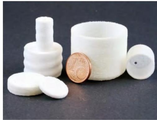
Abbildung 9: Mittels HT-SLS gefertigte poröse Glasformkörper
