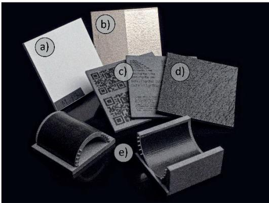
Abb. 1: Gefinishte Bauteile: a) pulverbeschichtet, b) metallisiert, c) laserstrahlbeschriftet, d) laserstrahltexturiert, e) 3D-laserstrahlpoliert
