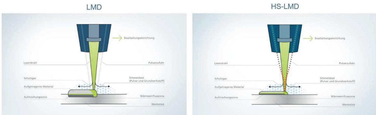
Abb. 1: Schematische Prozessansicht und Schichtaufbau sowie Wärmeinflusszone im Unterschied zwischen LMD (links) und HS-LMD (rechts).
