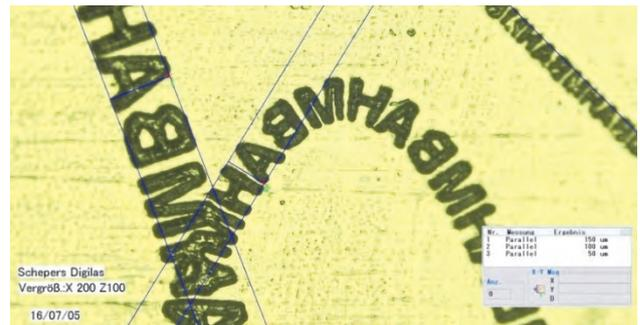
Abb. 21 Strukturierte Platte aus Abb. 19, gedruckt auf ein Papiersubstrat im R2R-Verfahren
