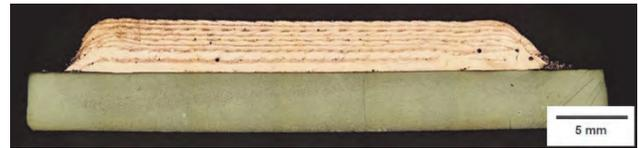
Abbildung 7: Schliffbild einer Probe aus CuCr1Zr auf ein Stahlsubstrat
