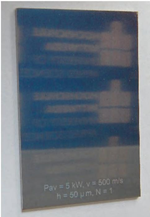
Abbildung 5: Makroskopische Aufnahme einer bearbeiteten Fläche
