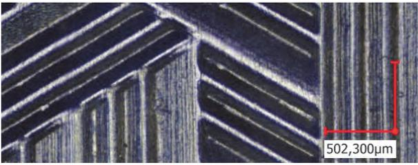
Abb. 22 Draufsicht auf ein geprägtes Aluminiumblech mit 1 mm Dicke
