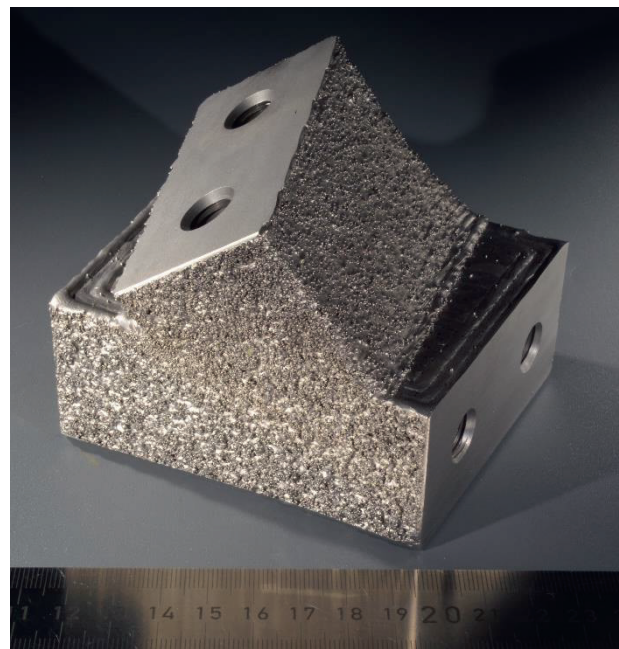
Abb. 1: Erste Demonstratoren aus Edelstahl (V2A) zum neu entwickelten Makro-SLM-Verfahren. Links : 3D-gedrucktes Benchy (Bauzeit 1h und Masse 2,2 kg). Rechts : Knotenelement für freigeformte Fassaden (Bauzeit 1,5h und Masse 3,5 kg). Funktionsflächen wurden mittels CNC nachbearbeitet.
