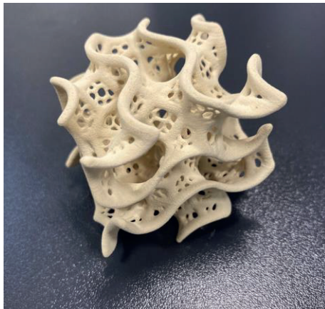
Abb. 1: Gyroid aus Titandioxid-Keramik mit Kantenlänge 5 cm, hergestellt mittels SLS und nachträglicher Sinterung.
