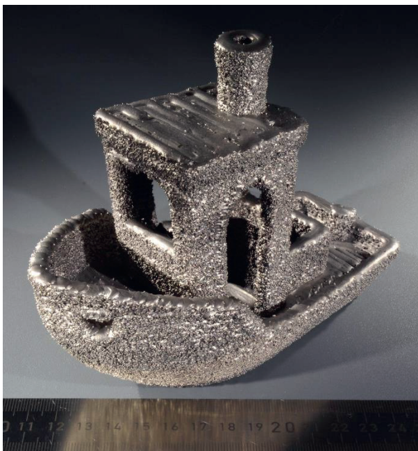
Abb. 1: Erste Demonstratoren aus Edelstahl (V2A) zum neu entwickelten Makro-SLM-Verfahren. Links : 3D-gedrucktes Benchy (Bauzeit 1h und Masse 2,2 kg). Rechts : Knotenelement für freigeformte Fassaden (Bauzeit 1,5h und Masse 3,5 kg). Funktionsflächen wurden mittels CNC nachbearbeitet.
